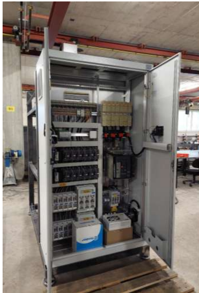
Vorverkabelter Schaltschrank
